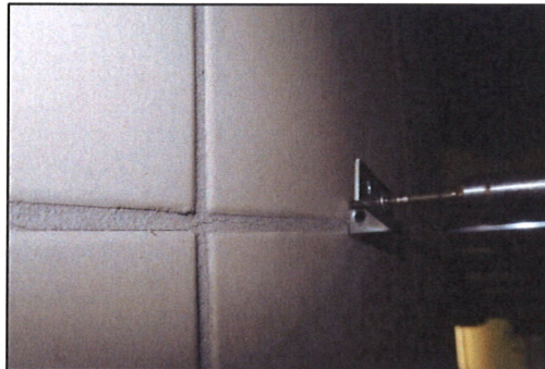
Obrázek 6: Zkušební těleso (konvexní), uvolnění soudržnosti ve spárovací maltě
